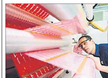
Eine Kaschieranlage bei Henkel, auf der Folien zu flexiblen Verpackungen verklebt werden. Foto: Henkel
